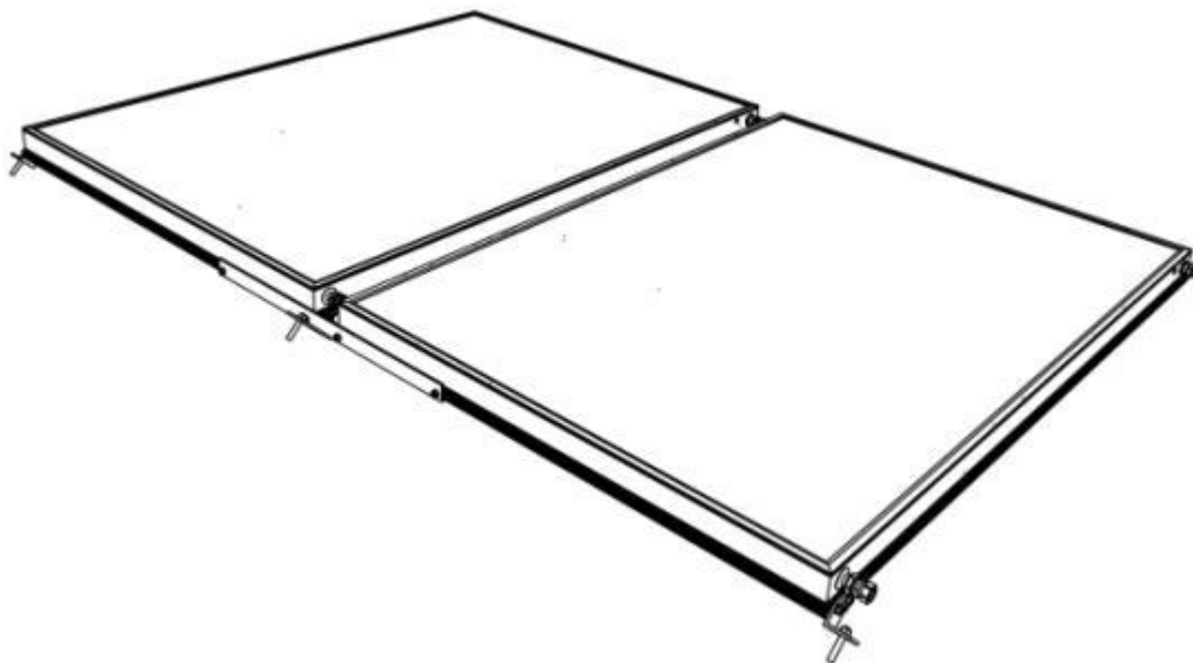
Εικόνα 1: Οι δύο συλλέκτες έτοιμοι προς εγκατάσταση με τους πάνω και κάτω συνδέσμους και τα δύο πέλματα εγκατεστημένα.
